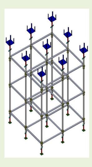
Опоры под перекрытие чашечного типа предназначены для поддержания элементов опалубки при бетонировании монолитных железобетонных конструкций, как с горизонтальной так и с наклонной поверхностью при строительстве зданий, мостов и туннелей. Максимальная высота опор - 18м. Опалубка перекрытий Сир-Lock состоит: Стойка чашечная, горизонтальный элемент, домкрат верхний, домкрат нижний, вставка соединительная
